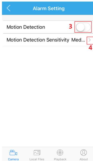
4. Seleccione una sensibilidad de detección de movimiento y presione en regresar para volver al menú de **Configuración de Alarma**. Mientras más alta sea la sensibilidad, más fácilmente será para la cámara captar el movimiento.
